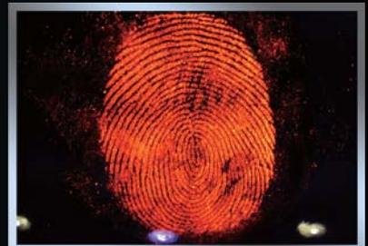
MG-P4 (紫外光) 拍摄已蘸荧光指纹粉的指纹痕迹
