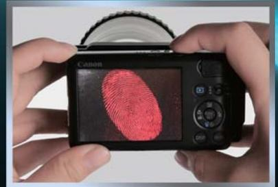
MG-P4 (白光) 拍摄杂志封面上已蘸粉的指纹痕: (30倍镜头倍率 / 3cmX2cm视野)
