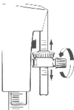
Pour la calibration du volume avec une balance analytique, utilisez l'écrou du système de réglage fin, le déplacer vers le bas, ce qui augmentera le volume. Le déplacer vers le haut, diminuera le volume délivré.
