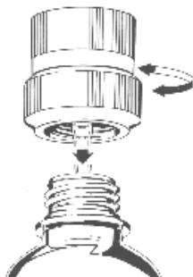
Avvitare il dosatore direttamente sulla flangia filettata (GL 32). In caso di filettatura diversa o di recipienti con collo levigato, utilizzare l'adattatore. Controllare che il dosatore sia applicato correttamente. Grazie all'adattatore FIX, il dosatore può essere ruotato in qualsiasi posizione e bloccato sul recipiente polmone.
