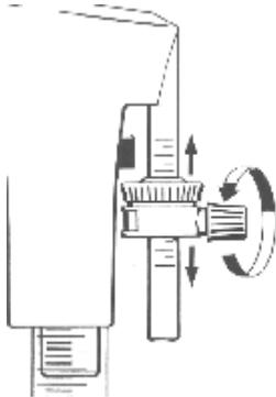
Per la registrazione di precisione del volume richiesto, ruotare il dado di registrazione di precisione sopra ad una bilancia per analisi. Ruotando verso il basso, il volume aumenta, verso l'alto il volume viene ridotto.
