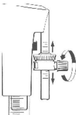
Zur genauen Feinabstimmung des gewünschten Volumens über eine Analysenwaage die Feinjustier-Mutter drehen. Nach unten drehen bedeutet größeres Volumen, nach oben drehen bedeutet kleineres Volumen.
