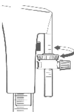
Para la determinación precisa del volumen deseado utilizando una balanza para análisis, girar la tuerca de ajuste de precisión. Girando hacia abajo se incrementa el volumen, girando hacia arriba se reduce.
