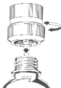
Den Dispenser direkt auf Gewindeflasche (GL 32) aufschrauben. Für andere Gewinde oder Behälter mit Schliffhals Adapter verwenden. Auf festen Sitz achten. Durch den FIX Adapter kann der Dispenser in jede gewünschte Stellung gedreht und auf dem Vorratsbehälter arretiert werden.
