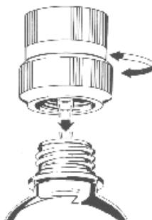
Enroscar el dispensador directamente sobre la botella con cuello de rosca (GL 32). Para otras roscas o recipientes con cuello liso utilizar un adaptador. Comprobar que ha encajado firmemente. Con el adaptador FIX, el dispensador puede girarse a cualquier posición que se deseé y bloquearse sobre el recipiente de reserva.
